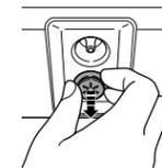
2. Changez le filtre à air. Enlevez le filtre à air usagé avec un objet pointu et introduisez le filtre à air neuf.
