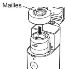
6. Appuyez jusqu'au déclic sur le couvercle du récipient de médicament pour le mettre en place. Le bouchon filtrant est fixé.
