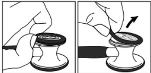
Зажмите ободок диафрагмы на стороне малого размера; потяните и снимите диафрагму с оливы.
