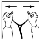
Ziehen Sie die Ohrbügel auseinander, um die Federspannung zu reduzieren.
