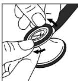
Membraani paigaldamiseks eemaldage kummiröngas. Asetage membraani serv tihidisse ning suruge see rinnaoatsaku ümber kinni.
