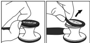
Pincer le rebord de la membrane sur le petit côté ; tirer et soulever la membrane du pavillon.
