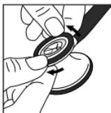
Per installare il diaframma, rimuovere la ghiera antifreddo. Inserire il bordo del diaframma nella scanalatura e arrotolare il bordo attorno alla testina.
