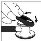
將防寒圈一側置於聽頭的邊緣，將其套在聽頭的邊緣，藉此連接防寒圈。
