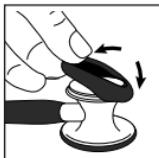
Przymocować obwódkę poprzez umieszczenie jednej strony na krawędzi i rozciągnięcie jej z nałożeniem na głowicę.
