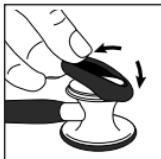
Encaixe a manga posicionando um lado na borda esticando-a sobre o auscultador.
