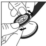
Чтобы установить диафрагму, снимите не вызывающий ощущения холода обод-рукав. Вставьте край диафрагмы в паз и прокрутите обод вокруг оливы.
