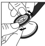
Diyaframı takmak için, üşütmeyecek halkayı çıkarın. Diyaframın kenarını oluğa yerleştirin ve göğüs parçasının etrafına geçirin.
