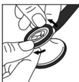
Da montirate membranu, uklonite prsten koji ne hlađi. Unesite ivicu membrane u brazdu i okrećite obod oko glave stetoskopa.
