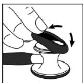
将防寒圈一侧置于听诊头的边缘，将其套在听诊头的边缘，借此连接防寒圈。
