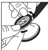
Če želite odstraniti membrano, morate odstraniti nastavek, ki preprečuje hladen občutek. Rob membrane vstavite v utor obroča in obroč razgrnite okoli glave.
