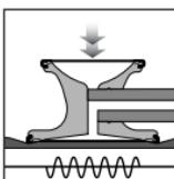
*Visoke frekvencije:* primenite jak pritisak na glavu stetoskopa
