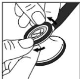
要想安装振动膜，请将防寒圈移除。将振动膜的边缘插入沟槽内，旋转边缘将其安装到听诊头。
