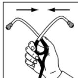
Для збільшення тиску пружини стисніть вушні трубки в напрямку одна до одної.
