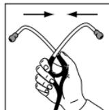
Drücken Sie die Ohrbügel zusammen, um die Federspannung zu steigern.
