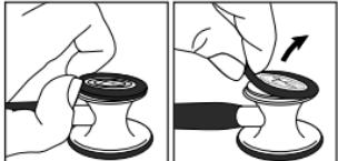
Drücken Sie den Rand der Membran auf der kleinen Seite zusammen, ziehen Sie sie und heben Sie die Membran vom Bruststück.
