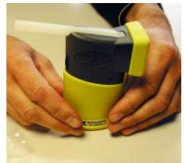
**1.** Saisir l'extrémité de l'embout d'une main et, de l'autre, coincer l'extrémité avec l'orifice latéral dans le coin de l'enveloppe
