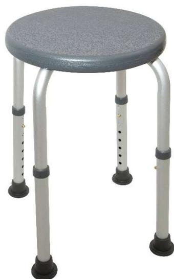
Cadre en aluminium anodisé (6061T5), épaisseur alu: 1,25mm. Hauteur: 36cm-54cm, 8 encoches réglables.
