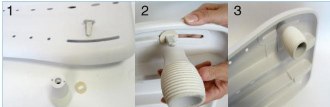
**Gegebenenfalls die Plastikscreuben oben aus den Anschlagbolzen herausdrehen. Je Schlitz am Badebrett eine Schraube von oben nach unten durchstecken, Gummiringe von unten dagegen stecken (Bild 1+2) und die Anschlagbolzen von unten leicht aufschrauben (Bild 3). Noch nicht festziehen, damit die Anschlagbolzen nachher innerhalb des Schlitzes auf die Wannenbreite eingestellt werden können.**
