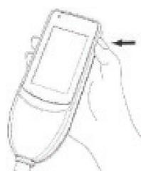
2. Maintenir enfoncé l'interrupteur d'alimentation 5 secondes pour allumer l'appareil et accéder au menu.
