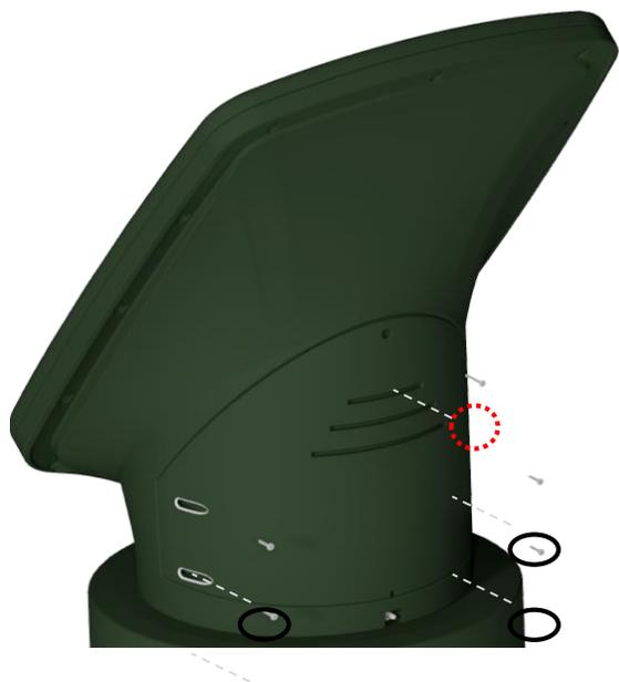
Remonter la trappe arrière en utilisant les vis fournies. Attention l'une des vis ici en ROUGE en 5x30 est plus longue que les 4 autres en 5x20.
