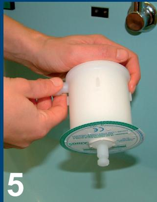
Enlever le bouchon de purge. Retourner le filtre et laisser s'écouler l'eau résiduelle.
