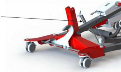
2. Retirer l'écrou de verrouillage et soulever le châssis principal jusqu'à ce qu'il atteigne le logement de base.
