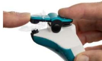
3. Poussez la partie inférieure du couvercle vers l'intérieur comme indiqué sur la photo, jusqu'à ce que le couvercle couvre la partie inférieure du capteur.
